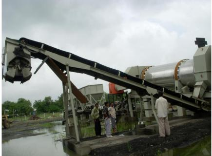
Fig. Load Out Conveyor
